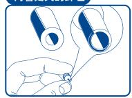
利用薄壁技術研製的針咀使針咀內 管闊大,令注射的阻力減少。
